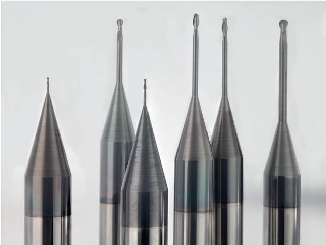
1 Die vielseitigen VHM-Mikrofräser des Systems FM-Line sind als Torus-, Schaft- und Vollradiusfräser ab einem Durchmesser von 0,2 mm verfügbar © Dümmel
